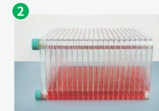
2 将CellFac®细胞工厂朝有进液口的一面缓慢侧放,使液面平衡
