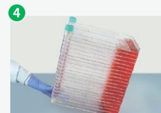
4 手握住进液口的一面,缓慢将CellFac®细胞工厂倾斜放倒,变为水平放置,放入细胞培养箱中孵育培养
